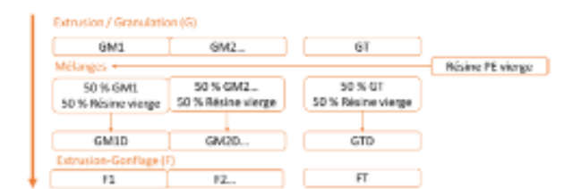
Figure 3 : Descriptif des étapes du protocole d'extrusion-gonflage
