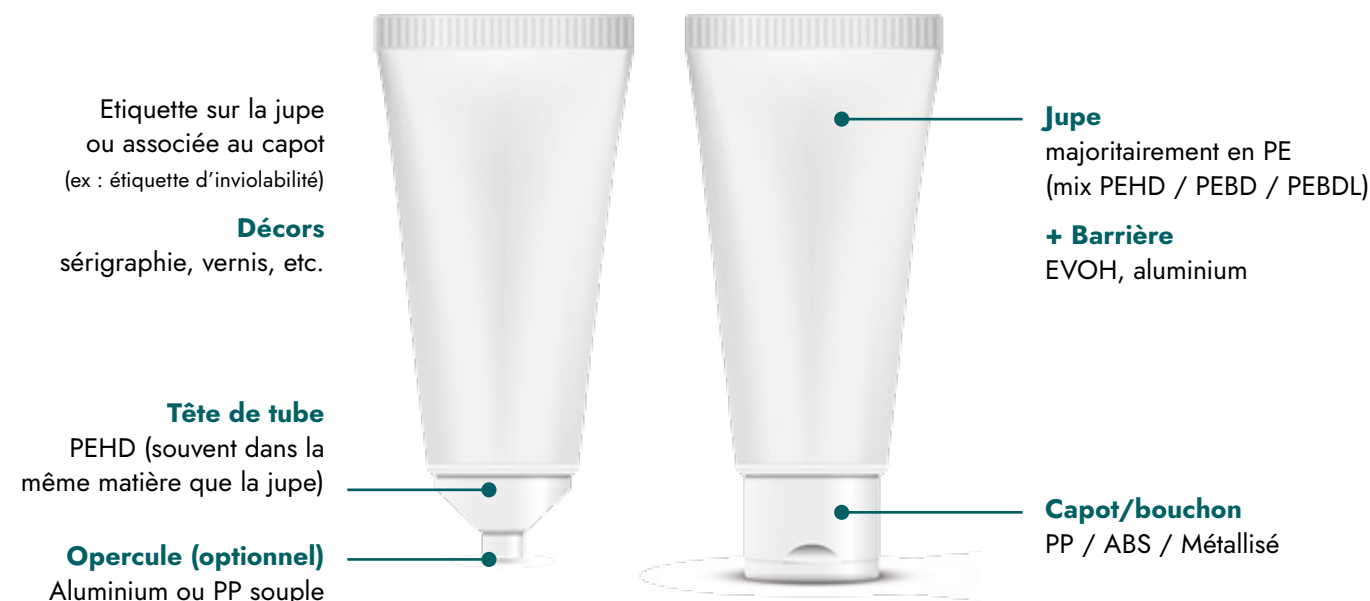
Figure 8 : Description d'un tube standard majoritairement en PE
