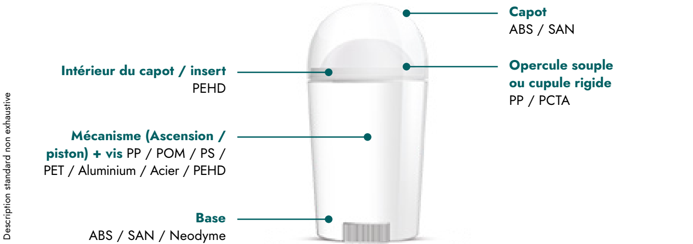
Figure 11 : Description standard non exhaustive d’un stick type déodorant
